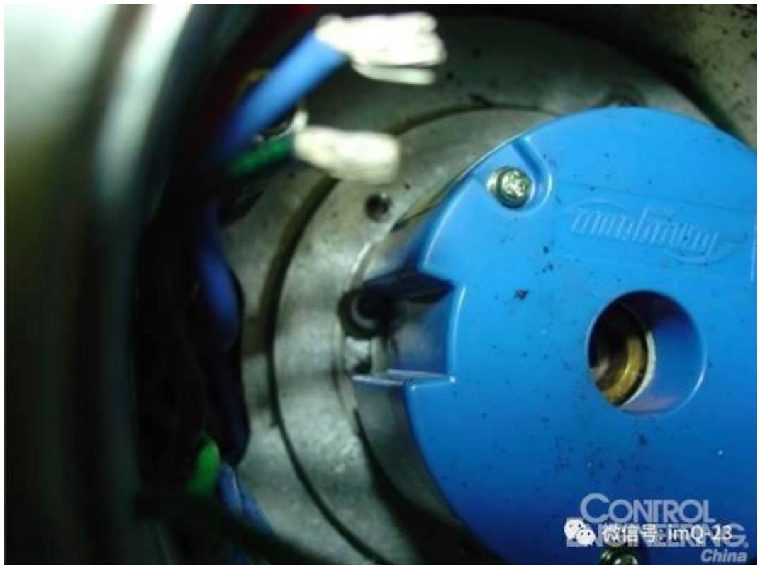
从污染物方面看，正像前文所说，伺服反馈编码器的防护等级大都在 IP20 ~ IP40，如果伺服电机在运转时，其输出轴长期受到过大的轴向或径向力作用，会造成电机轴和轴承的磨损，从而在电机内部产生大量粉尘和碎屑，它们不仅可能会因为附着在反馈编码器的线路板上导致其内部电路的损坏，也有可能因为大量堆积而影响电气元件的散热和机械轴承的润滑。而这其实和伺服电机自身所具备的防护等级并没有太大关系。
