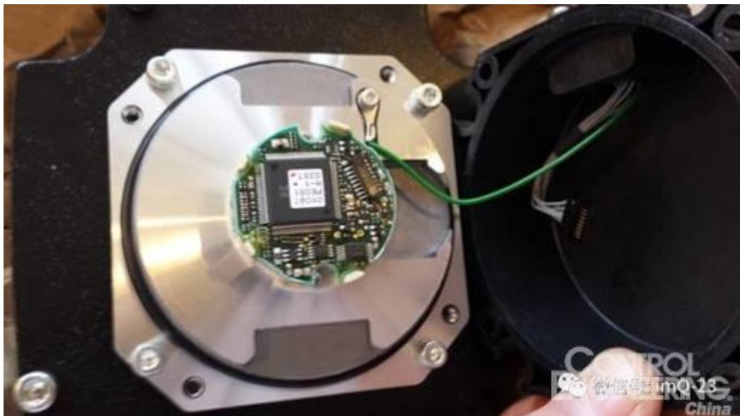
另一方面，编码器外部线路的异常，例如：短路、断路、接错线、极性接反、电源异常（如波动）... 等等，也都可能造成伺服反馈的电气故障或损坏。
