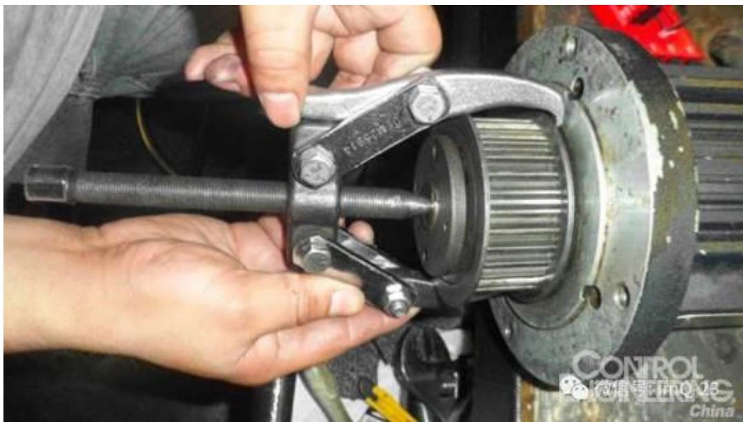
因此，在使用伺服电机过程中，须尽量避免其本体受到任何外力的撞击，尤其要防止对电机输出轴的冲撞和敲击，无论是来自轴向或径向的，例如：在往电机输出轴上安装各种传动轴套（同步带轮、联轴器、减速机轴套... 等等）时，或者在将电机安装到传动机构的过程中，切勿用力敲击电机轴和外壳本体。
