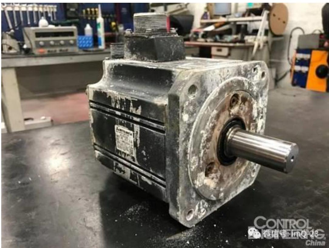
很多故障伺服电机返厂后的维修报告里，都会提到反馈编码器因受到污染物的侵蚀而损坏，例如：浸液、粉尘... 等等。
