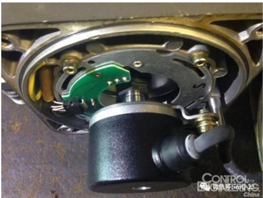
还有一些情况，振动是在电机运行过程中伴随机械轴旋转而引起的，例如：伺服电机轴输出侧受到过大的轴向力作用，在运转时发生前后窜动造成编码器机械
