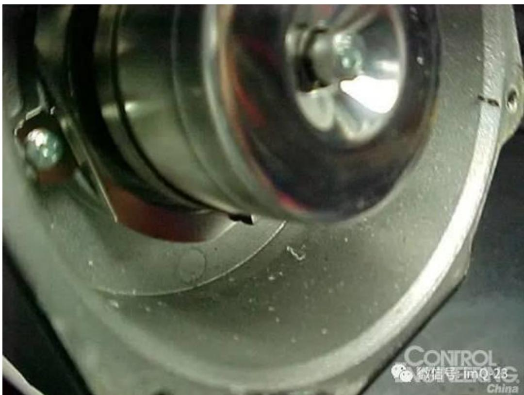
还有一种电气损坏是伺服反馈所特有的，是由于电机的机械损伤而引起的。如果伺服电机在运转时，因其输出轴长期受到过大的轴向或径向力作用，造成轴和轴承的磨损，就会在电机内部产生大量金属屑和粉尘，当这些金属粉尘附着在反馈编码器的线路板上时，极有可能因短路而造成其内部电路的故障或损坏。
